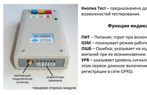
Кнопка Тест – предназначена для дополнительных возможностей тестирования.
