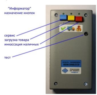
Кнопка Инкассация («Мешок с деньгами») - сбрасывает счётчики суммы накопленной наличности и рассылает уведомления. Следует нажимать, когда аппарат инкассируется.
